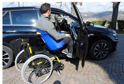
Le **harnais** relié au Handylift est **robuste**, en **tissu respirant** et **lavable** est disponible en trois tailles (S - M - L) . Avec ses trois points de rotation horizontaux et son système de levage électrique, ce système permet à la personne d'être transférée rapidement et facilement.
