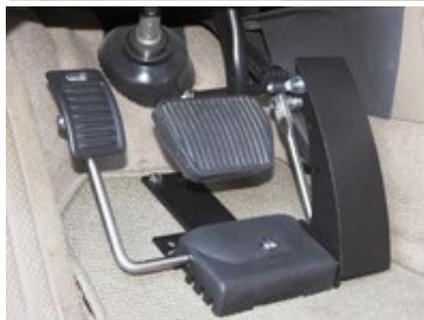
**REMARQUE: Conception universelle** pouvant être installée sur les véhicules avec conduite à droite ou à gauche, et sur la plupart des marques et des modèles de véhicules.
