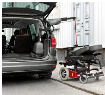
2. La **plateforme élévatrice Joey Lift** : située à l'arrière du véhicule permet de soulever et charger le fauteuil roulant dans un véhicule. Vous roulez et fixez simplement le fauteuil roulant sur la plateforme depuis l'extérieur du véhicule, vous appuyez sur la télécommande et c'est tout. L'élévateur Joey est une des solutions les plus compactes du marché et ne gêne pas du tout la banquette arrière.
