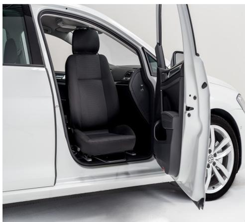
**Turnout** est une **embase pivotante** conçue pour tous ceux qui ont du mal à entrer dans un véhicule ou à passer du fauteuil roulant au siège.
