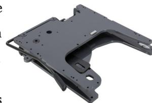
**Turnout** permet de faire pivoter le siège vers l'extérieur et d'avancer de quelques centimètres pour se rapprocher de l'utilisateur. Elle existe en différents modèles pour les passagers et les conducteurs.
